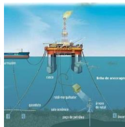
Cabos de Ancoragem
