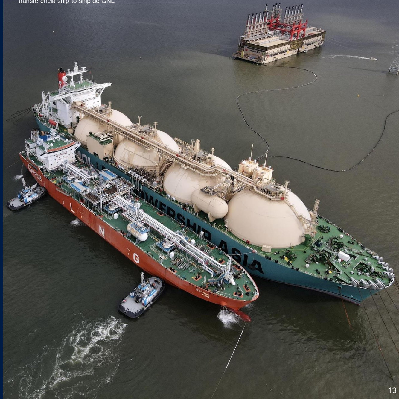
Rebocadores WS auxiliando uma transferência ship-to-ship de GNL
