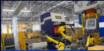
Nova linha de Eixos Came – Forjaria totalmente automatizada pela Auttom
